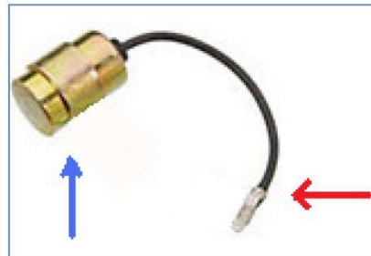
Figure 2 Billede af "original" kondensator (IKKE ThorCap). Kondensatoren kan også have mange andre udformninger, men alle kondensatorerne bruger samme princip med en forbindelse til stel og en forbindelse til kontaktsættet (eller LT ledningen).
