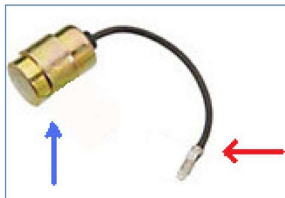
Figure 2 Image du condensateur «original» (PAS ThorCap). Le condensateur peut aussi avoir beaucoup d'autres conceptions, mais tous les condensateurs utilisant le même principe avec une connexion de bloc moteur (masse) et une connexion de disjoncteur de contact (ou fil LT).
